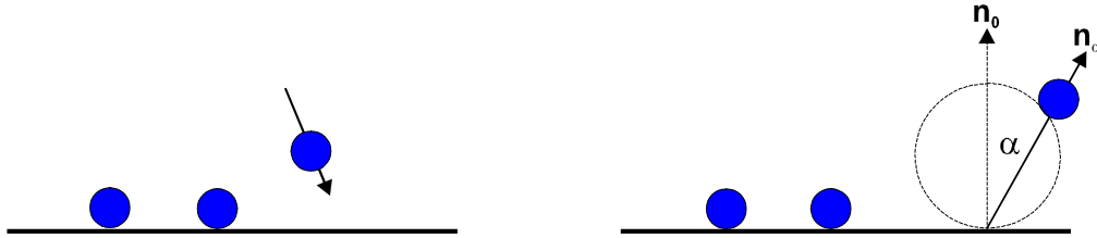
Figure 6 - Réflexion d'une molécule sur une paroi fixe. : n_{\alpha} = n_0 \cdot \cos \alpha .
