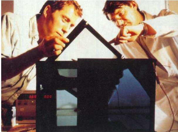
Exemple de vitre électrochrome à différents stades de polarisation (Saint-Gobain)
