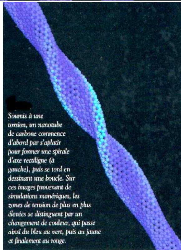
Simulation d'un essai de torsion
