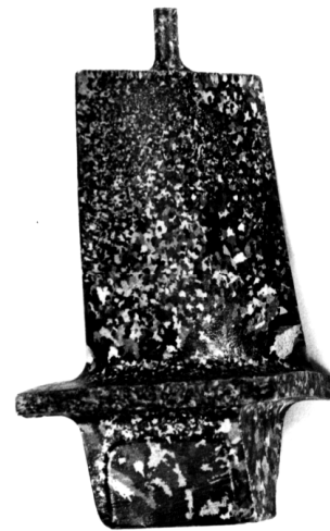
Structure polycristalline à gros grains
