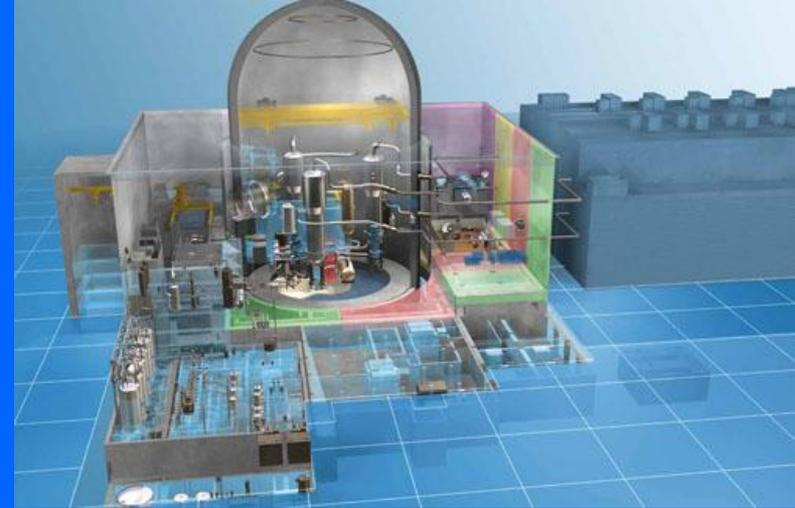
Réacteur à eau pressurisée à 3 boucles, l'ATMEA1 est conçu avec un cœur à faible densité de puissance capable d'opérer en cycles de 12 à 24 mois.
