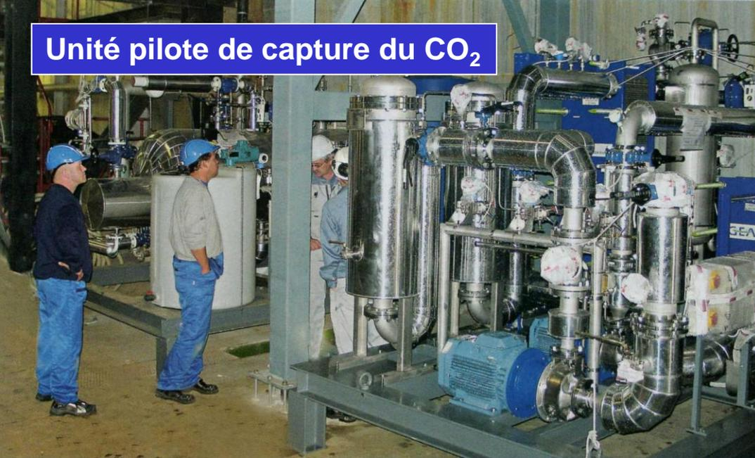
Une partie du CO<sub>2</sub> est incorporée dans un cycle Ca pour former du CaCO<sub>3</sub> solide, le reste étant comprimé et injecté dans un site géologique.
