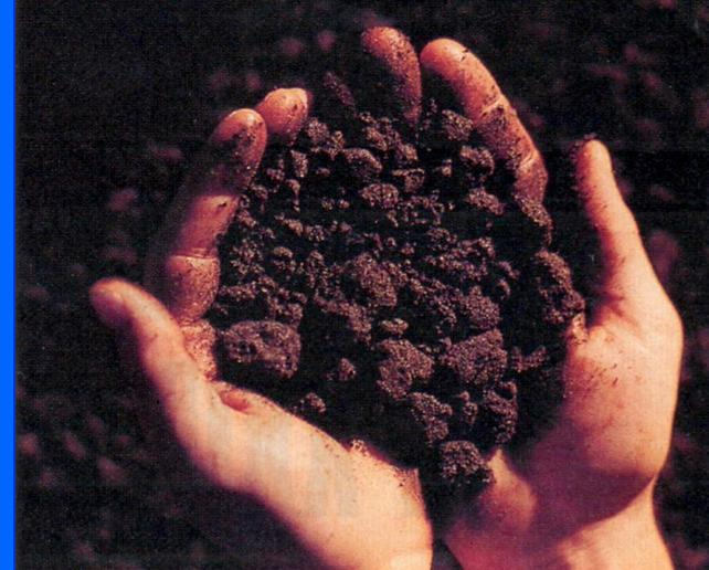
COUVERTS DE BITUME, les grains de sables asphaltiques ressemblent à du marc de café.
