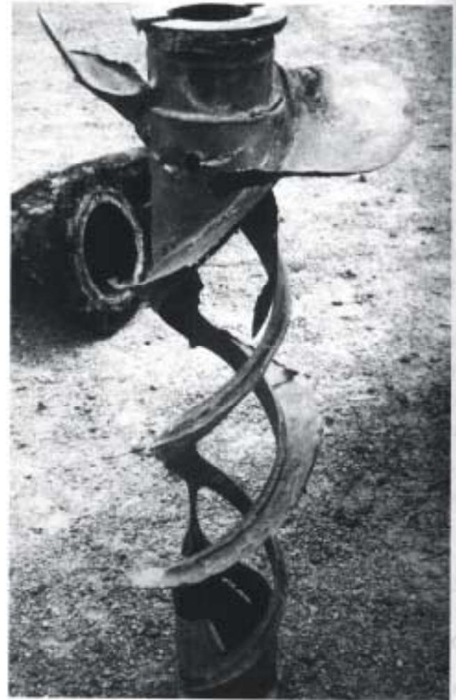
Figure V.1.3. - Érosion-corrosion d'un agitateur en acier inoxydable à 20% Cr, 25% Ni, 4,5% Mo et 1,5% Cu en milieu phosphonique contenant des particules abrasives (silice et gypse) et des impuretés (chlorures et fluorures).
