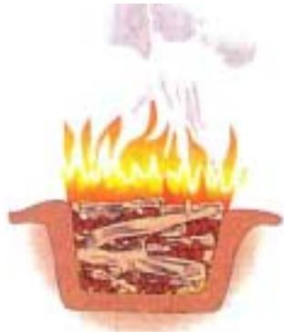
Le minerai de fer est d'abord chauffé avec le bois (1), ce qui permet d'éliminer l'humidité, d'accroître la surface de réaction et de réduire partiellement le minerai.
